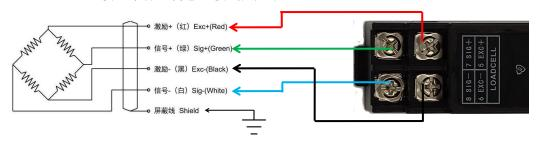
注意:连接2个及以上的传感器时,需要使用接线盒,并且供电电源只能使用直流6V。
