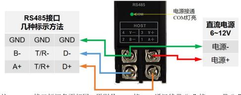
注: RS485 接口标识各不相同。原则是 GND 接 V-,通讯线带 "+"接 A+,带 "-"接 B-;连接好后,打开配置软件,按下图操作打开串口,然后再给 DS-D3B 重新上电。
