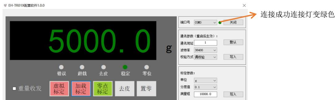
软件固定使用的是 EH-TR010 默认通讯参数和他进行通讯。如果 EH-TR010 不是使用的默认通讯参数，则可能出现无法连接的情况。此时保持软件处于串口打开的状态，给 EH-TR010 重新上电，EH-TR010 会自动初始为默认通讯参数。
